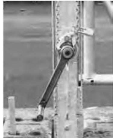
Die Handkurbel verfügt über eine Rückschlagsicherung, so bleibt die gewünschte Höheneinstellung bestehen. Zusätzlich ist die Kette mittels Vorhängeschloss abschließbar.
