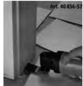
Dieses Messer ist geeignet für Holz, Gipskarton und Kunststoffe. Die breiten Formen bringen eine höhere Schnittgeschwindigkeit bei Holzplatten und Leisten
