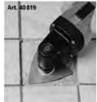
Mit der HM-Schleifplatte können Sie Fliesenkleber, Zement oder Putz plan abschleifen
