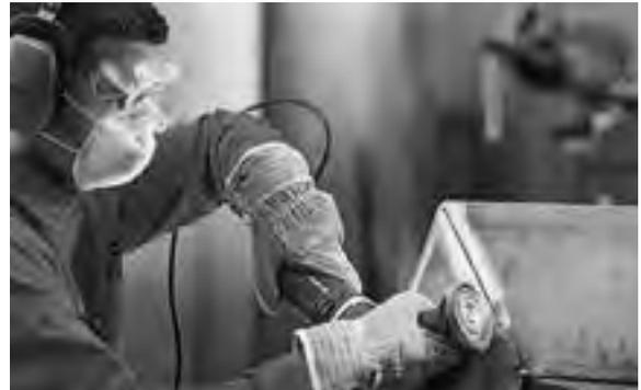
Stahlplatten werden zum Schweißen vorbereitet.
