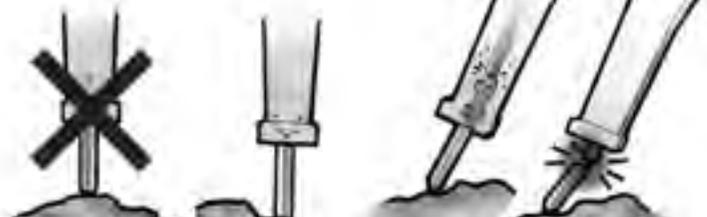
Wenn das Werkzeug an einer schrägen Fläche angesetzt wird entstehen starke Brechkkräfte im Werkzeug die zum Bruch führen können.
