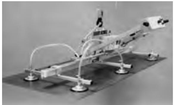
Zum horizontalen Transport von Blechen, KS-Platten, Glasscheiben, beschichteten Holzplatten, dichten und glatten Steinplatten und sonstigen, in sich dichten Werkstoffen.
