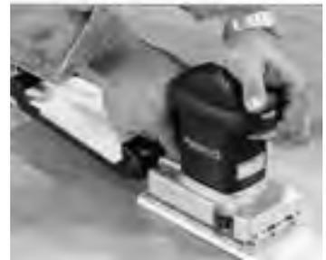
Aufstehende Holzfasern mit einer Hand-schwingschleifmaschine abschleifen.
