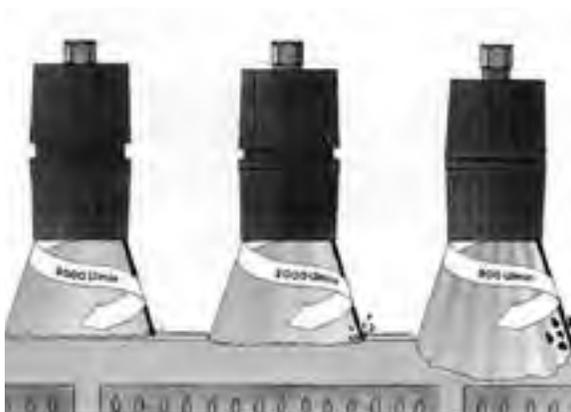
Je langsamer die Drehzahl desto stärker ist der Aufpralldruck
